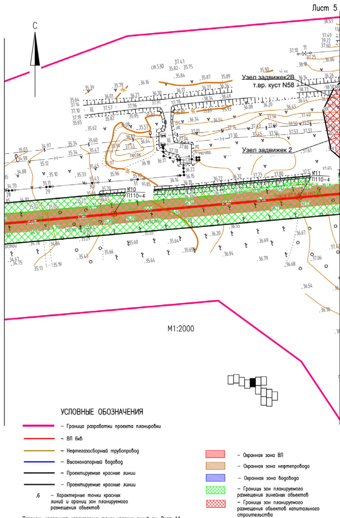
Чертеж границ зон планируемого размещения линейных объектов.
