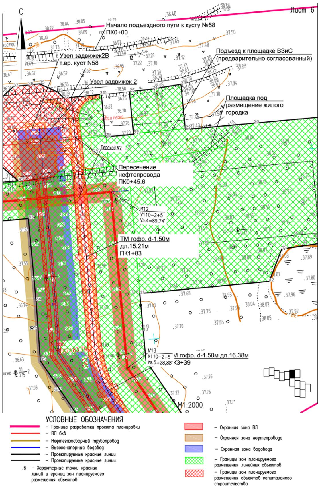
Чертеж границ зон планируемого размещения линейных объектов.
