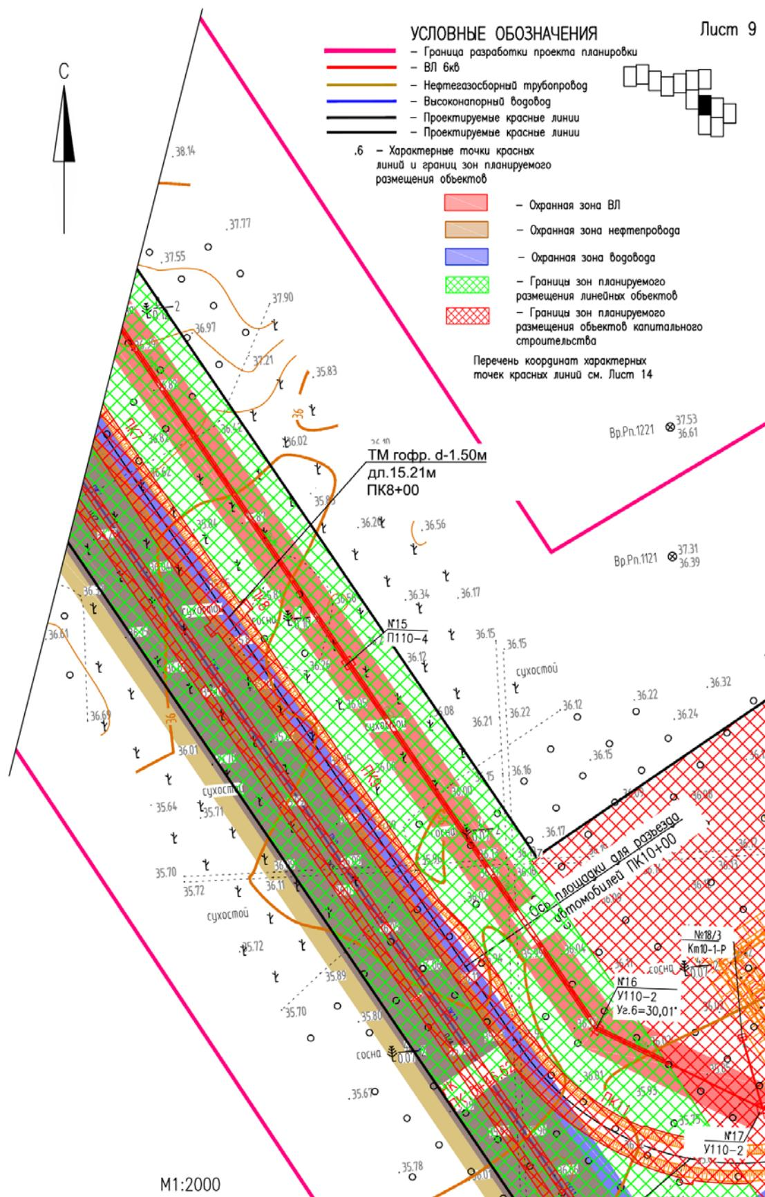
Чертеж границ зон планируемого размещения линейных объектов.
